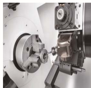
Обработка наклонных отверстий с помощью универсального держателя
